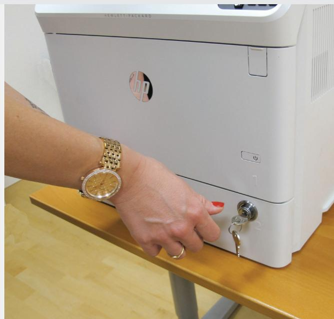
ESI France a développé un système pour sécuriser les papiers et les documents de valeur dans l'imprimante. Le rajout d'un verrouillage par système à clé permet de protéger du vol et de l'usage abusif du papier et des documents sensibles.
